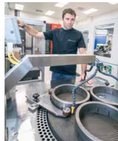
Die Läppmaschine «ELAP 700» zur Vorbearbeitung der Aufspannfläche der Werkstücke.
