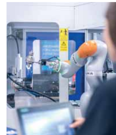
Der in die Ultrapräzisionsdrehmaschine integrierte Roboterarm «LBR iiwa 14 R820» von KUKA.
