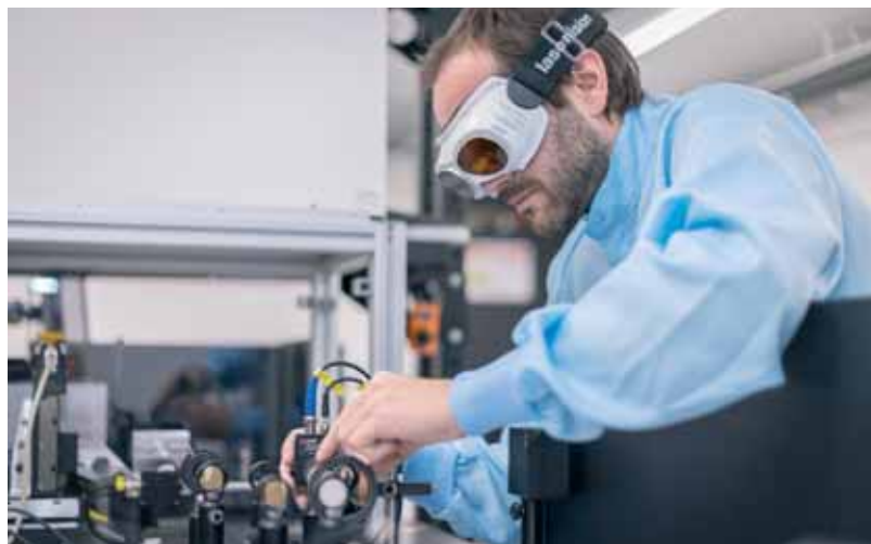
Einrichten der optischen Messtechnik für die LIDT-Messung (Laser Induced Damage Threshold-Messungen = laserinduzierte Zerstörungsschwellenmessung).
