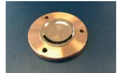
Das vorbearbeitete Werkstück vor der Diamant-Zerspangung auf der «MTC 650 UP» (oben) und nach Beschichtung durch das Institut für Mikro- und Nanotechnologie der NTB (unten).
