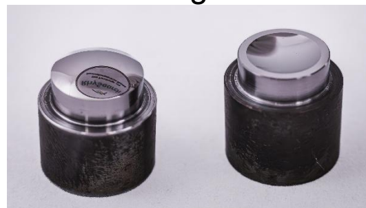
Ultrapräzisionsdrehen und Koordinatenmesstechnik für höchste Oberflächenqualität
