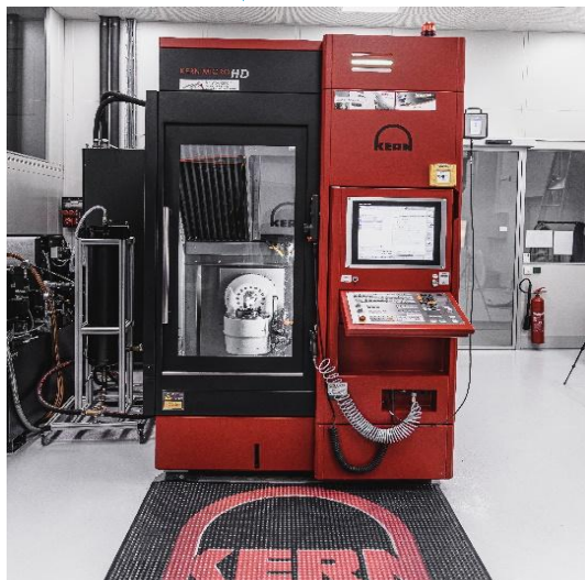
5-Achs-Bearbeitungszentrum Kern-Microtechnik «Micro HD» (Werkstückgenauigkeit < 2 \mu\text{m} )
