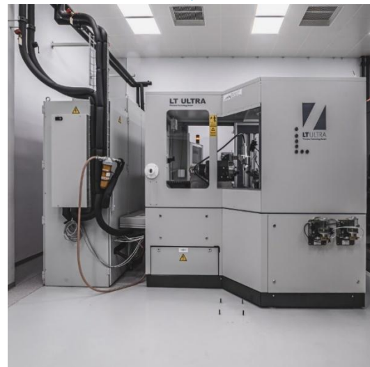
Ultrapräzisionsdrehmaschine LT-Ultra «MTC 650 UP» (Werkstückgenauigkeit < 0.1 \mu\text{m} )
