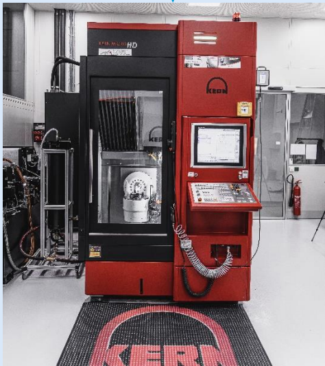
5-Achs-Bearbeitungszentrum Kern-Microtechnik «Micro HD» (Werkstückgenauigkeit <math><2 \mu\text{m}</math>)
