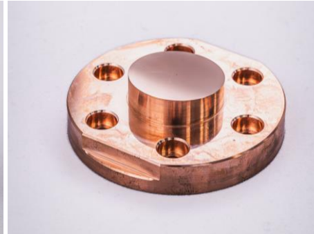
Ultrapräzisionsdrehen für höchste Oberflächenqualität
