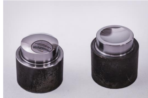
Ultrapräzisionsdrehen für höchste Oberflächenqualität
