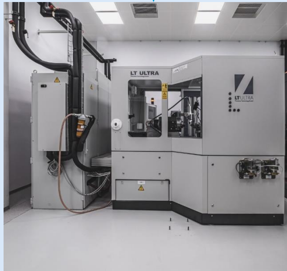
Ultrapräzisionsdrehmaschine LT-Ultra «MTC 650 UP» (Werkstückgenauigkeit <math><0.1 \mu\text{m}</math>)
