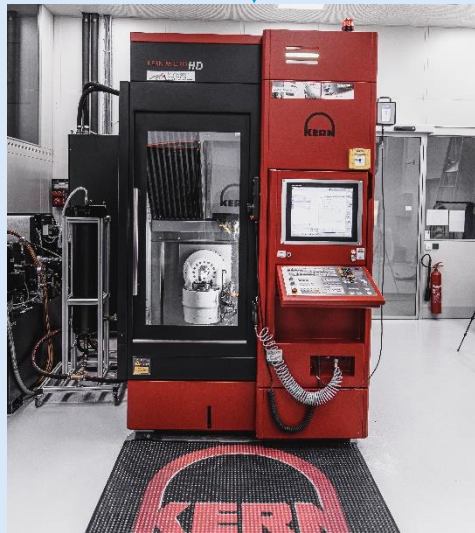
5-Achs-Bearbeitungszentrum Kern-Microtechnik «Micro HD» (Werkstückgenauigkeit <math><2 \mu\text{m}</math>)
