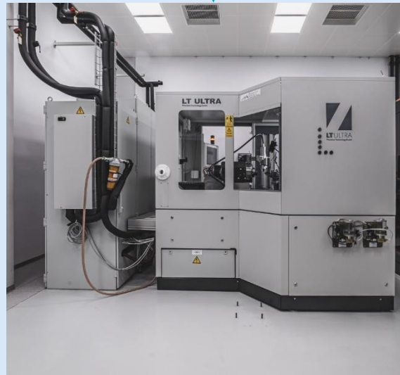
Ultrapräzisionsdrehmaschine LT-Ultra «MTC 650 UP» (Werkstückgenauigkeit <math><0.1 \mu\text{m}</math>)
