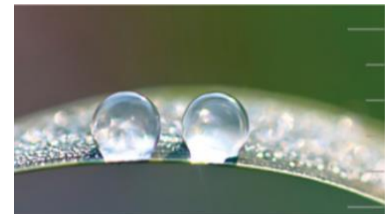
Easy-to-clean Beschichtungen für die Uhrenindustrie von Blösch
