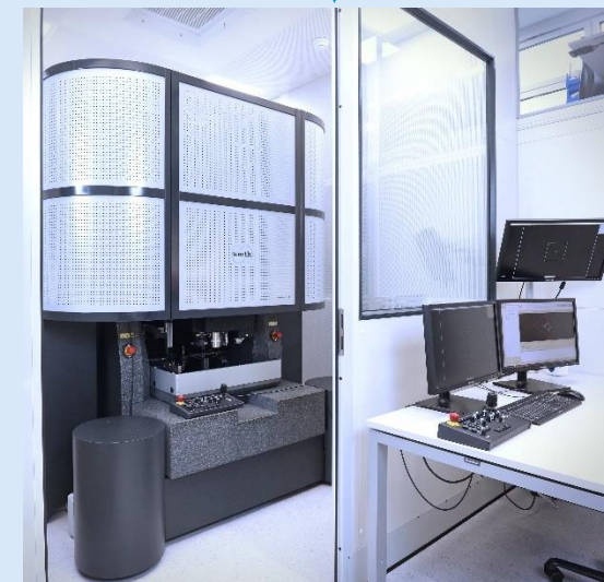
Multisensorik- Koordinatenmessgerät WERTH «VideoCheck UA» (Messunsicherheiten <math><0.1 \mu\text{m}</math>)
